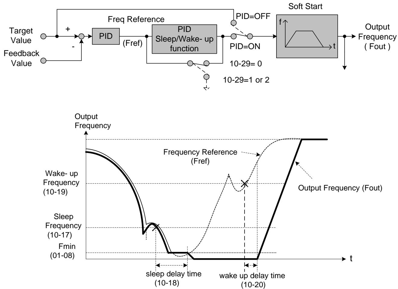
**Fig. 4.4.83 PID Sleep Function**
